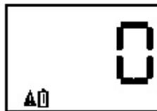
2.2.3.3. Когда батарея разряжается до такого состояния, что уже не может обеспечить нормальную работу прибора, раздается громкий звуковой сигнал и дисплей приобретает следующий вид:
