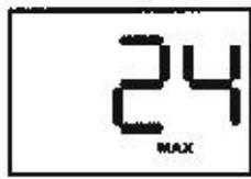
2.2.2.3. Если после появления на дисплее максимальной концентрации нажать кнопку РЕЖИМ, на дисплее отображается текущее время. Точка, расположенная ниже двоеточия с часами и минутами, указывает на вечернее время.
