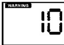
После этого на дисплее отобразится концентрация, соответствующая значению Порога 2 для данного газа. Дважды вспыхнет светодиод и дважды прозвучит звуковой сигнал, частота которого в 2 раза выше частоты звукового сигнала при отображении Порога 1. При этом в правом верхнем углу дисплея появится предупреждающая надпись, и дисплей принимает следующий вид:
