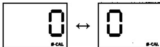
После этого на дисплее начинается повторный 5-секундный обратный отсчет времени. По завершении этого отсчета появляется значение текущей концентрации. Прибор находится в режиме измерений. Градуировка газоанализатора СЕАН-О<sub>2</sub> на этом заканчивается.
