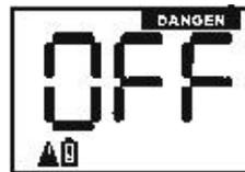
2.2.3.4. Газоанализатор сигнализирует при необходимости произвести корректировку нуля с помощью баллона с нулевым воздухом (содержание токсичных газов менее  $10^{-4}$  %, содержание кислорода 20,9%). При наступлении срока проведения корректировки в левом и правом углах дисплея появляются предупреждающие знаки, и дисплей приобретает следующий вид:
