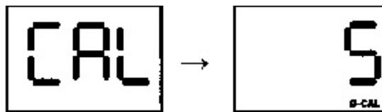
Для завершения процедуры установки нуля нажмите кнопку РЕЖИМ до окончания 5-секундного обратного отсчета. Если калибровка прошла успешно, на дисплее попеременно появляются следующие сообщения:
