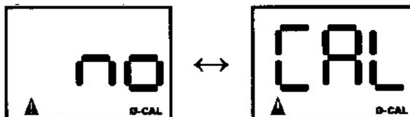
Затем газоанализатор переходит в режим измерений. В этом случае установку нуля следует повторить. При повторной неудаче следует обратиться на предприятие-изготовитель. Использование прибора, на котором не установлен ноль, запрещается.
