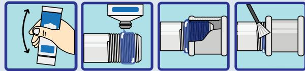
Встряхните тубик, нанесите равномерно гель из тубика на всю окружность резьбы на глубину предполагаемой скрутки. Скрутите соединение с любым усилием затяжки (возможна ручная сборка, без ключей). Соберите выдавившейся гель кистью из набора и перенесите на следующую резьбу.
